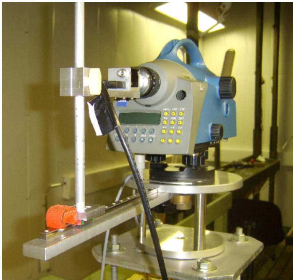
Рис.6 Нивелир с видеокамерой
